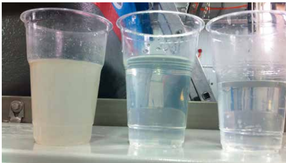
► Рис. 8. Пробы сточных вод: до флотатора (слева), после флотатора со средним расходом реагентов (в центре), с увеличенным расходом реагентов (справа)
