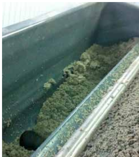
► Рис. 6. Флотошлам с низкой влажностью
