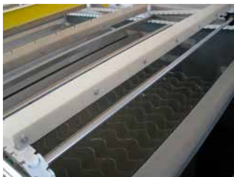
► Рис. 2. Примеры использования пластин во флотационном резервуаре
